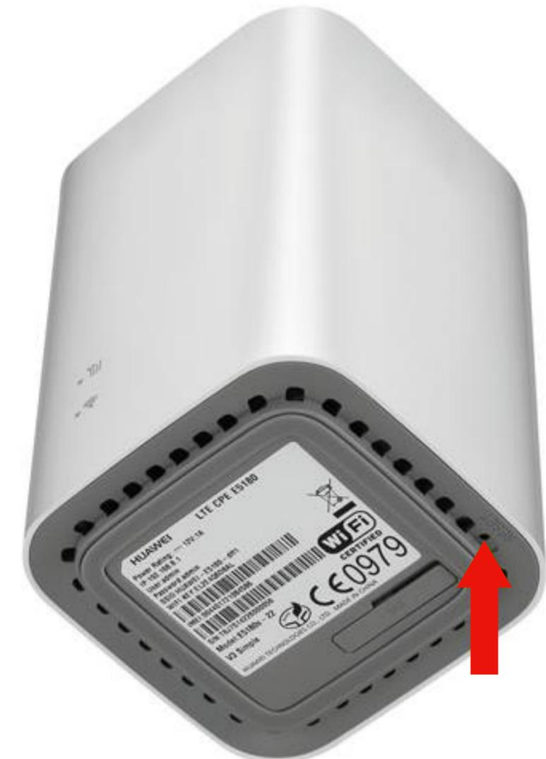
**Für Reset: Hier Nadel einführen und 10 Sekunden Taste im Inneren gedrückt halten.**
